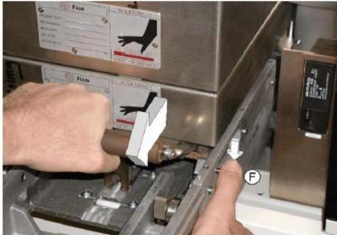
Gambar IV.21 Letak kenop pengunci  *mold*  pada  *mold slide adapter*
