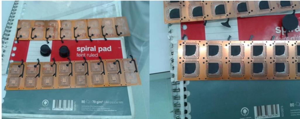
Gambar. Hasil *molding* mode *short shots* (kiri) stop posisi 9mm (kanan) stop posisi 7mm
