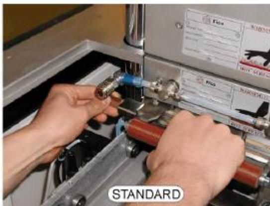
Gambar IV.20 Letak kenop pengunci *mold* pada mesin
