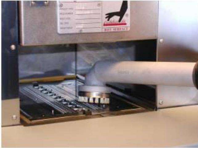
Gambar : Pembersihan Permukaan Mold dengan  *Hand Vacuum Cleaner*
