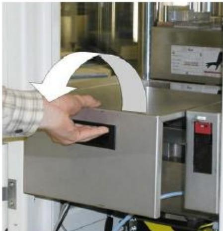
Gambar IV.17 Cara membuka penutup mesin *press*
