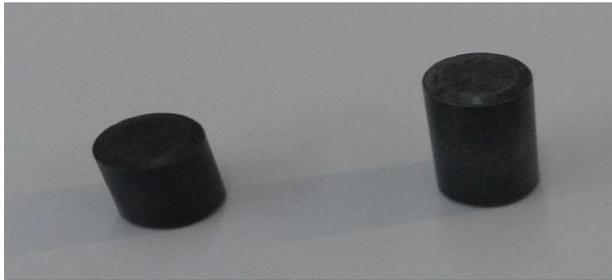
Gambar IV.24 *Pellet* (kiri)*production pellet* (kanan)*conditioning pellet*
