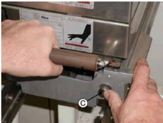
Gambar IV.22 Letak kenop pengunci  *mold*  pada  *mold carrier*
